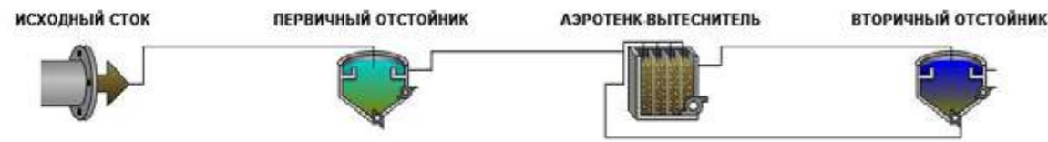
Рисунок 1 Модель рассматриваемой станции очистки сточных вод.
